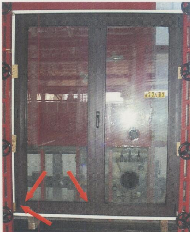
Foto 1: Indicazione dei punti di infiltrazione di acqua alla pressione di 600 Pa
